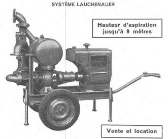
Débits de 1 à 500 litres/seconde. - Pas de soupape de pied, ni de clapet dans la tubulure d'aspiration. Aucune pompe à vide de secours. - Réamorçage automatique immédiat, même si de l'air est entré dans le tuyau d'aspiration. - Pas de surface de contact à frottement et s'usant; par conséquent, pas de contretemps même pour l'élévation de la boue, du sable ou du gravier.
