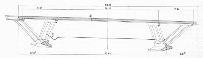
Fig. 1. — Coupe longitudinale dans l'axe du pont.
