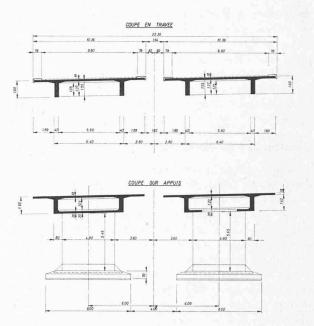
Fig. 4. - Coupes transversales du pont.
