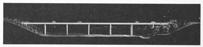
Fig. 1. — Première solution : 7 travées ; 6 piles intermédiaires nos II, III, IV, V, VI et VII ; les axes I et VIII correspondent aux 2 culées.
