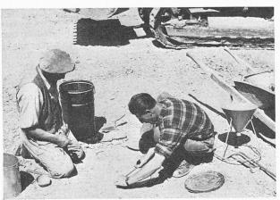
Photo nº 9. — Détermination de la densité sur place.
