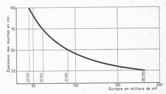
Fig. 11. — Surface totale à compacter en fonction de l'épaisseur des couches.
