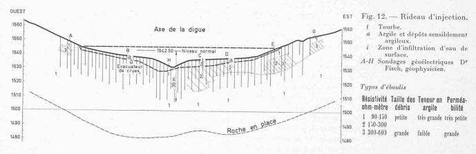
La position du rideau d'injection fut choisie un peu en amont de l'axe de la digue. Quant au produit d'injection, après des essais infructueux avec de l'Opalit, on adopta une matière plus fine encore, la Bentonite (fig. 12).
