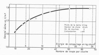
Fig. 8. — Essai de compactage sous teneur en eau constante de 13 %.
