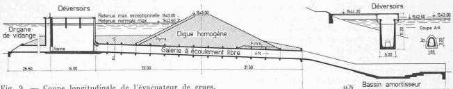
Fig. 9. — Coupe longitudinale de l'évacuateur de crues.
