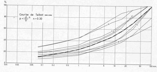
Fig. 13. — Composition granulométrique des terres de remblayage.
