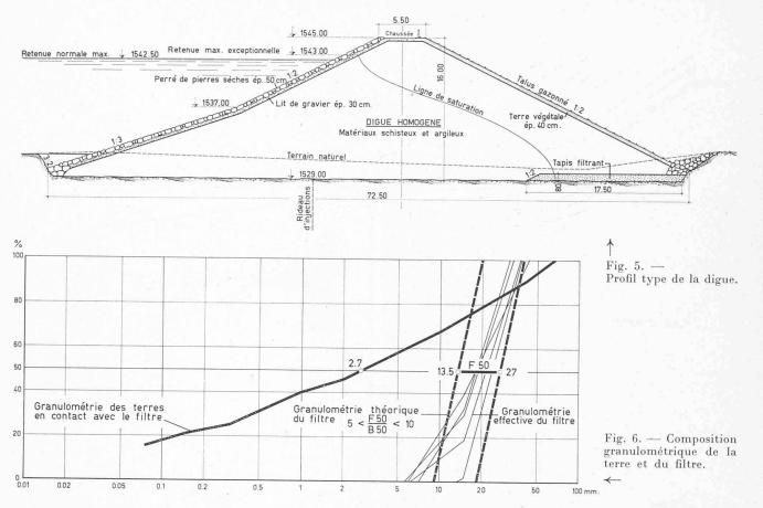
Ces caractères permettent de concevoir une digue homogène sans noyau étanche, les deux rôles (stabilité et étanchéité) étant assumés par un matériau unique.
