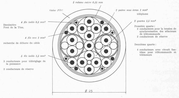
Fig. 29. — Coupe du câble des téléactions.
