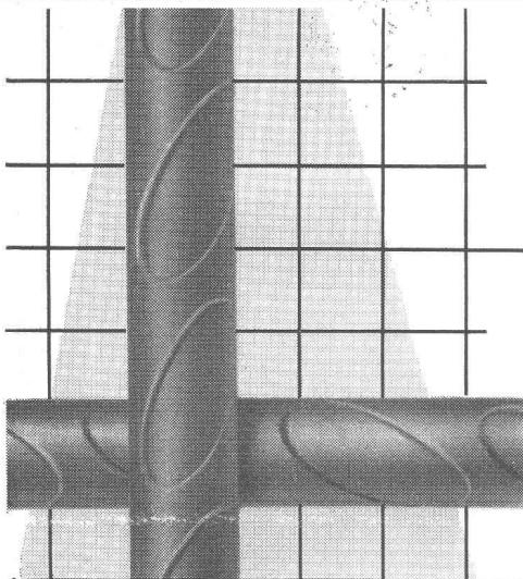
Le profil des treillis d'armature
