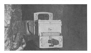
Ces bétonnières destinées au transport du béton en galerie existent en 3 grandeurs différentes: pour 1,5, 2,6 et 4 m³ de béton. La commande du tambour est assurée par un moteur silencieux à air comprimé qui ne consomme que 10,5 m³/min. Le solide tambour réversible (tôle de 7 mm) garantit un malaxage et une vidange impeccables.
