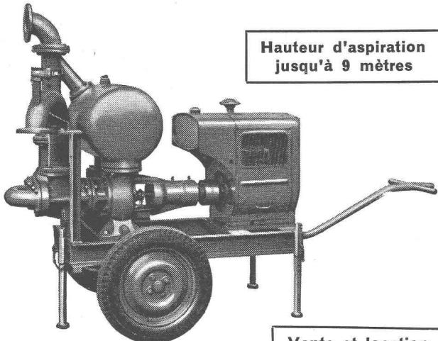
Débits de 1 à 500 litres/seconde. — Pas de soupape de pied, ni de clapet dans la tubulure d'aspiration. — Aucune pompe à vide de secours. — Réamorçage automatique immédiat, même si de l'air est entré dans le tuyau d'aspiration. — Pas de surface de contact à frottement et s'usant ; par conséquent, pas de contretemps même pour l'élévation de la boue, du sable ou du gravier.
