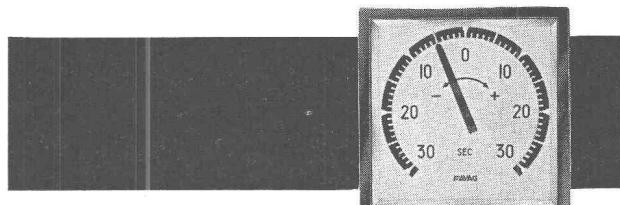
Dans une centrale électrique, on contrôle la régularité de la fréquence à l'aide du fréquencemètre FAVAG.
