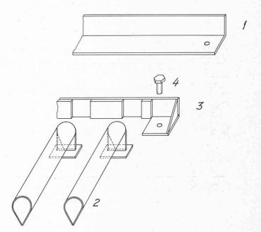
Fig. 4. — Détail des grilles à espacement réglable. Vue perspective des divers éléments à l'angle d'une grille suivant, l'ordre de pose :
