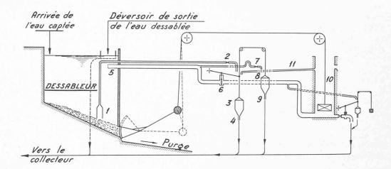
Fig. 6. Schéma du dispositif de commande automatique de la purge du dessableur par aspiration.
