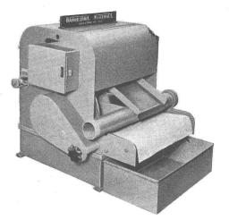
Epurateur de liquide d'arrosage à filtre magnétique et textile combinés
