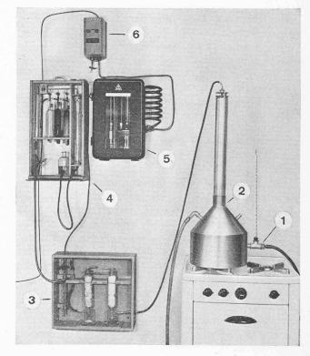
Fig. 3. — Analyse des gaz brûlés.
