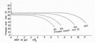
Fig. 4. — Caractéristiques d'un régulateur de pression.
