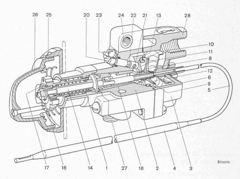
Fig. 5. — Coupe longitudinale d'un régulateur de température.
