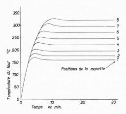
Fig. 6. — Caractéristiques d'un régulateur de température.
