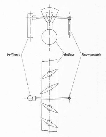
Fig. 9. — Disposition idéale d'une sécurité à thermocouple.
