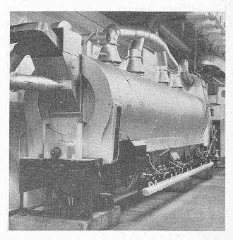
Fig. 8. — Installation de torréfaction de tabac.
