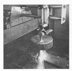
Fig. 2. — Chalumeau oxy-coupeur fonctionnant au gaz de ville.
