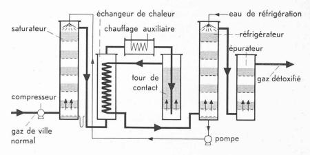
Fig. 5. — Schéma d'une installation de détoxification par le procédé de la conversion catalytique.
