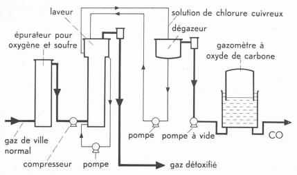
Fig. 6. — Schéma d'une installation de détoxification par le procédé par lavage.
