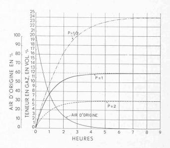
Fig. 4. — Concentration en gaz dans un local de 50 m³, ayant une fuite de 6 m³/h., en fonction de la vitesse d'aération.
