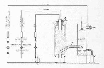
Fig. 3. — Installation de craquage autothermique et catalytique étudiée par *Gaz de France* (type P 2).
