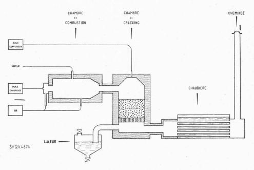
Fig. 2. — Schéma d'une installation ONIA-GEGI pour le craquage thermique et catalytique des huiles de raffinerie.
