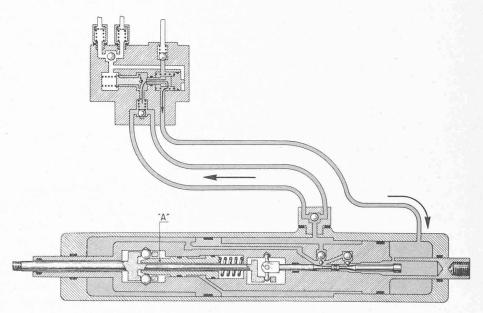
Fig. 2. — Servo-commande « Jaccottet-Leduc ». Fonctionnement mécanique.
