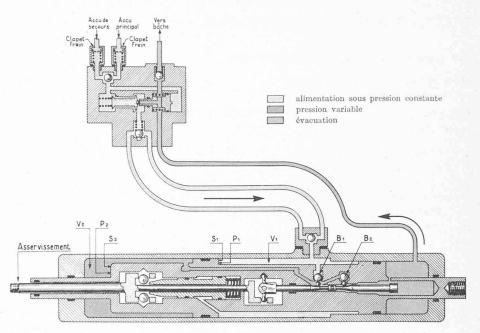
Fig. 1. — Servo-commande « Jacottet-Leduc ». Fonctionnement hydraulique.
