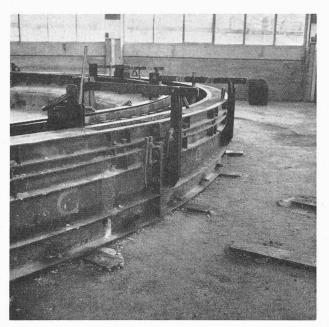
Fig. IV/12. — Coffrage métallique d'un voussoir, vue partielle.
