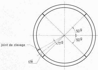
Fig. IV/10. — Disposition des joints.
