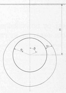
Fig. IV/2. — Répartition des pressions sur un tunne circulaire, d'après Caquot.
