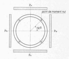
Fig. IV/5. — Cas de charge symétrique de l'anneau complet.
