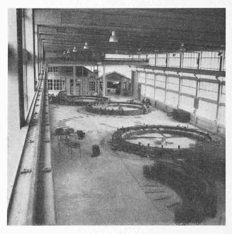
Fig. IV/11. — Fabrication des voussoirs, vue de l'atelier.
