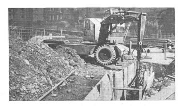
Modèle 154: contenance de la benne 1500 I, convertisseur de couple, inverseur de direction, essieux à engrenages planétaires, renversement vers l'arrière de la benne à proximité du sol: gaspillage minime, bras de levage de forme arquée (breveté) pour une securité accrue du conducteur.
