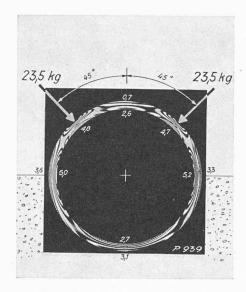
Fig. III/6. — Lignes isochromes ( $\sigma_I - \sigma_{II} = {\rm const.}$ ). Lumière monochromatique. Cas de charge M 4. Contraintes annulaires sur l'ouvrage :  $\sigma \ {\rm kg/cm^2} = 8,64 \ {\rm m}$  (+) traction (-) compression
