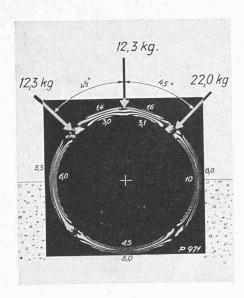
Fig. III/10. — Lignes isochromes ( $\sigma_I - \sigma_{II} = \text{const.}$ ) Lumière monochromatique Cas de charge A 8 Contraintes annulaires sur l'ouvrage :  $\sigma \text{ kg/cm}^2 = 8,72 \text{ m}$ (+) traction (-) compression
