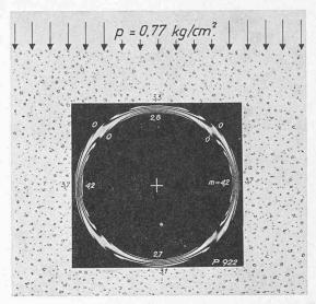
Fig. III/4. — Lignes isochromes ( $\sigma_I - \sigma_{II} = \text{const.}$ ). Lumière monochromatique. Cas de charge MO. Contraintes annulaires sur l'ouvrage : σ kg/cm² = 9,20 m (-) compression
