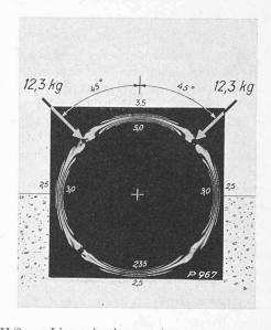
Fig. III/8. — Lignes isochromes ( $\sigma_I - \sigma_{II} = \text{const.}$ ). Lumière monochromatique. Cas de charge A 4. Contraintes annulaires sur l'ouvrage :  $\sigma \text{ kg/cm}^2 = 16,65 \text{ m}$  (+) traction (—) compression m = nombre de franges
