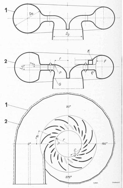
Fig. 2. - Profils hydrauliques des deux modèles de bâche Charmilles essayés au Laboratoire d'aérodynamique de l'Ecole polytechnique fédérale à Zurich.
