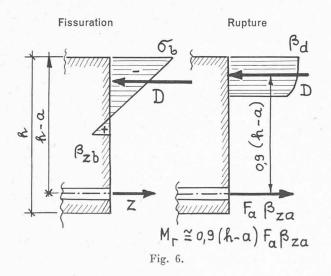
partir du début de la fissuration, le comportement du profil change et devient semblable à celui d'un profil en béton armé ordinaire : les câbles résistent alors à la manière des armatures de béton armé. La résistance du profil est assurée par les tractions dans les câbles, et par les compressions dans le béton. On cesse d'être dans le domaine du béton précontraint.
