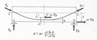
μ = Coefficient de frottement de l'appui
