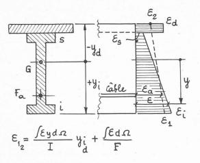
Fig. 9. - Fluage d'un profil composé.
