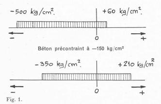
béton dont la capacité de résistance est comprise entre une compression de —500 kg/cm² et une traction de +60 kg/cm²; soumis à l'effet d'une précontrainte de compression de —150 kg/cm², sa capacité de résistance vis-à-vis des charges extérieures sera comprise entre —350 et +210 kg/cm². La frange d'utilisation a donc été décalée de 150 kg/cm² des compressions vers les tractions.
