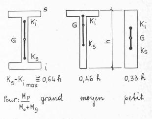
Fig. 10. — Formes des profils.
