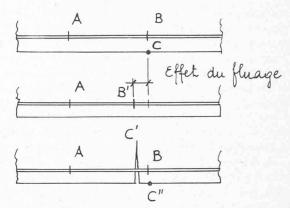
Fig. 14. — Effet d'une armature passive.
