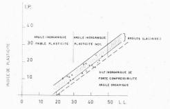
Fig. 2. — Caractéristiques des glaises. Compressibilité et indice de plasticité en fonction de la limite de liquidité LL.
