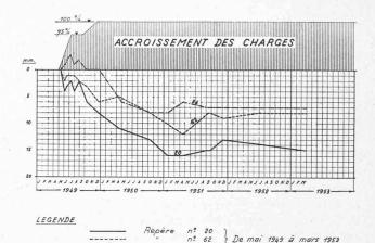
Fig. 8. — Tassements en fonction du temps aux points 20 et 62 sous façade sud, et 34 au nord.
