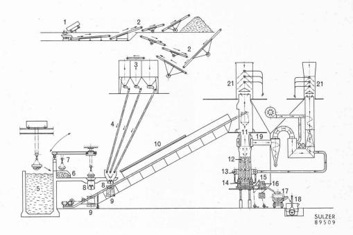
L'installation de réchauffage du vent fonctionne à contrecourant. Les gaz dégagés par le coke incandescent sont aspirés dans la cuve du cubilot et brûlés dans une chambre de combustion pour céder leur chaleur, dans un récupérateur, à l'air froid qui y circule en sens inverse. Ce réchauffage d'air jusqu'à 600° C permet d'obtenir des températures de fonte dépassant 1500° C, avec une consommation de coke moindre que précédemment.
