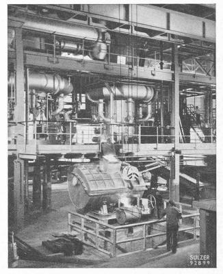
Fig. 13. — Vue antérieure de l'installation des cubilots.
