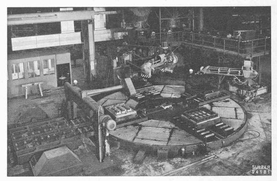
Fig. 15. — Plaque tournante, dispositif de remplissage, Slinger, machine à basculer et râcleuse à sable dans le moulage au vert pour fonte grise.
