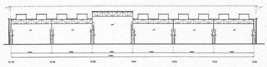
Fig. 3. — Coupe transversale par les halles de la fonderie; six halles d'une largeur de 24 m, dont cinq hautes de 15 m et une, pour la fonderie des grosses pièces, haute de 19,5 m. Construction métallique en treillis, lanternaux d'éclairage avec surfaces vitrées verticales.
