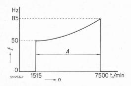
Fig. 5. — Valeurs numériques de la figure 4 pour un moteur triphasé 50 Hz, 4 pôles.
