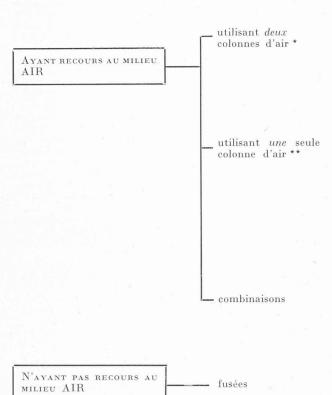
\* Une colonne « extérieure », participant à la propulsion (s'écoulant donc à travers l'hélice) et une colonne « intérieure », alimentant en oxygène le moteur à pistons ou la turbine.
