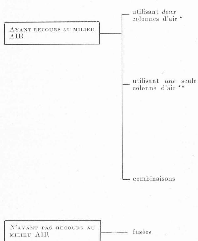
\* Une colonne « extérieure », participant à la propulsion (s'écoulant donc à travers l'hélice) et une colonne « intérieure », alimentant en oxygène le moteur à pistons ou la turbine.
