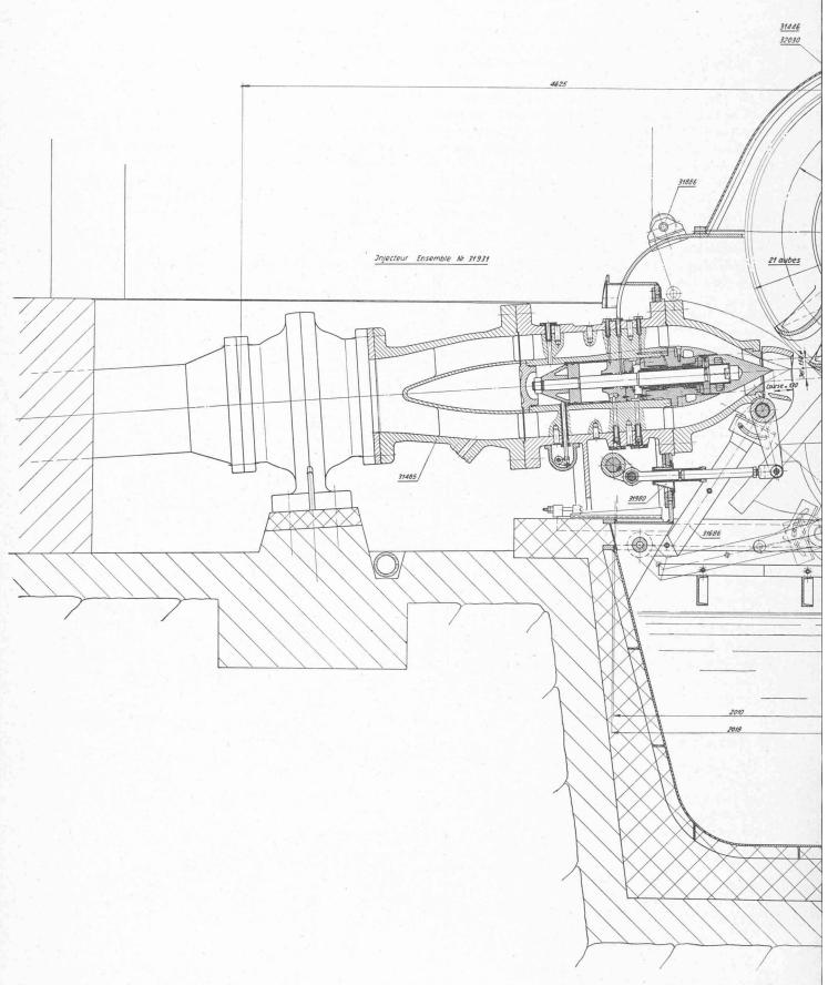
Fig. 5. — Lostallo : Coupe transversale de la turbine (Vevey).
