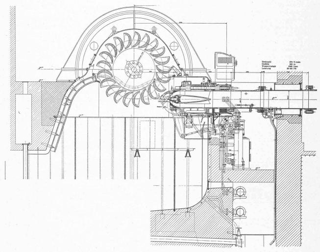
Fig. 6. — Cavergno: Coupe transversale de la turbine (Bell).
