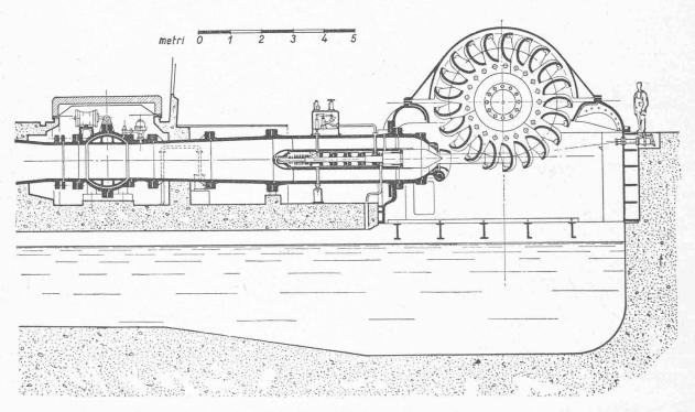
Fig. 2. — Cimego: Coupe transversale de la turbine (Riva).
