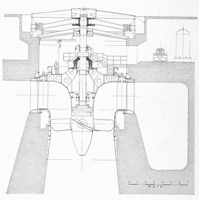
Fig. 14. — Isola Serafini: Coupe axiale de la turbine (Riva).
