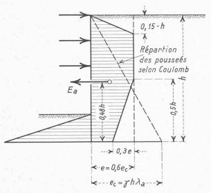
Fig. 9. — Exemple d'une hypothèse sur la répartition de la poussée des terres sur l'enceinte d'une fouille. (Publication de E. Menzenbach, Heft Nr. 18 de *Mitteilungen* aus dem Institut für Verkehrswasserbau, Grundbau und Bodenmechanik der Technischen Hochschule, Aachen.)
