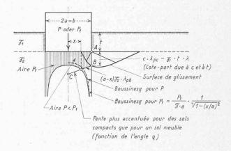
Fig. 2. — Modification des contraintes de contact sous une semelle rigide selon Boussinesq, par suite de la formation de zones plastiques sur les arêtes.
