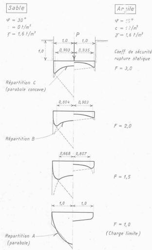
Fig. 3. — Répartition des contraintes sous une semelle rigide lors de l'accroissement de la charge.
