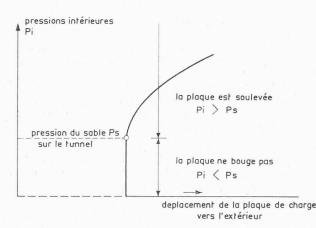
Fig. II/1. — Principe d'exécution des essais de charge avec plaques pour la détermination de la pression des terres sur le tunnel.
