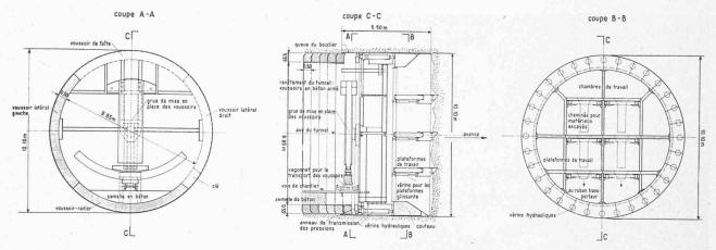
Fig. I/8. — Avance au bouclier, coupes en long et en travers.
