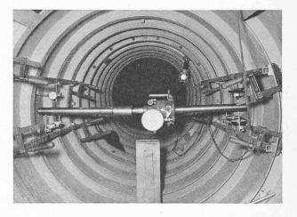
Fig. II/7. — Système de mise en charge des plaques et de mesure de leurs déplacements.
