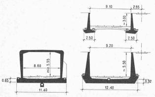
Fig. I/3. — Coupes caractéristiques des tranchées d'accès et du tunnel dans la partie construite à ciel ouvert.
