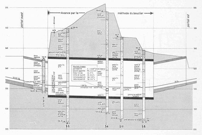
Fig. I/4. — Tunnel de Donnerbühl: profil en long géotechnique.
