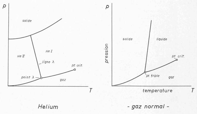
Fig. 3. — Comparaison des diagrammes d'état de l'hélium et d'un gaz normal (représentation schématique).
