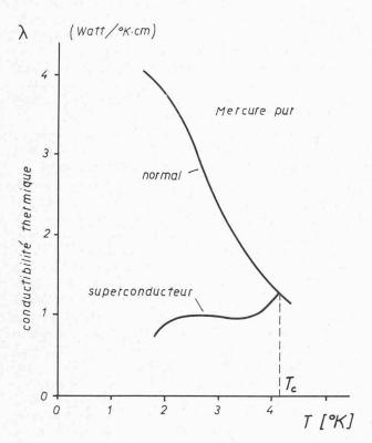
Fig. 4. — Conductibilité thermique du mercure dans l'état normal et superconducteur en fonction de la température.
