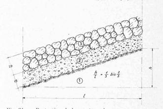
Fig. 34. — Protection de berge, type A. 1) Terrain naturel. — 2) Gravier 1-25 mm. — 3) Galets 50-100 mm.
