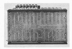
Ensemble de « plug-in » montés sur un tableau et reliés par circuits imprimés.
