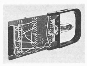
« Plug-in », face montrant les joints par bobinage.
