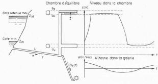
Fig. 4. — Exemple d'oscillation du plan d'eau et de la vitesse.
