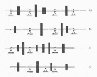
Fig. 9. — Configurations possibles d'un arbre avec ses paliers.
