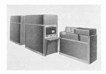
Fig. 1. — L'ordinateur IBM 650 à tambour magnétique.
