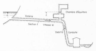
Fig. 3. — Schéma d'installation hydro-électrique.
