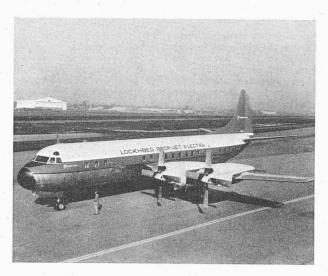
Fig. 2. — Vue du Lockheed « Electra », tel qu'il fut présenté à Cointrin. On remarque la forme caractéristique du fuselage ainsi que la position assez reculée de l'aile.
