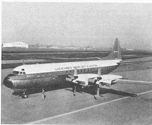
Fig. 2. — Vue du Lockheed « Electra », tel qu'il fut présenté à Cointrin. On remarque la forme caractéristique du fuselage ainsi que la position assez reculée de l'aile.
