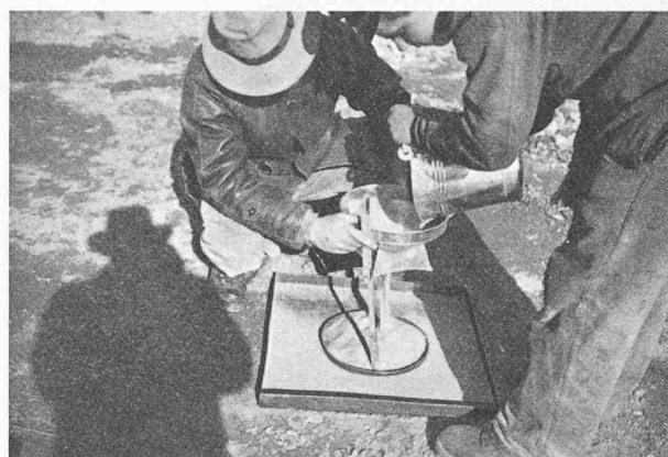
Fig. 10. — Détermination de la densité « in situ » — calibrage du volume du trou avec du sable versé d'une hauteur de 52 cm au travers d'un entonnoir.
