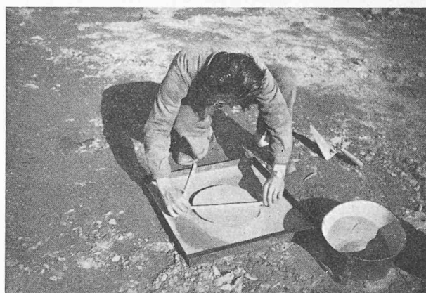
Fig. 11. — Détermination de la densité « in situ » — arasage du sable.
