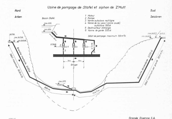
Fig. 1. — Profil en long du siphon et schéma de l'usine de pompage.
