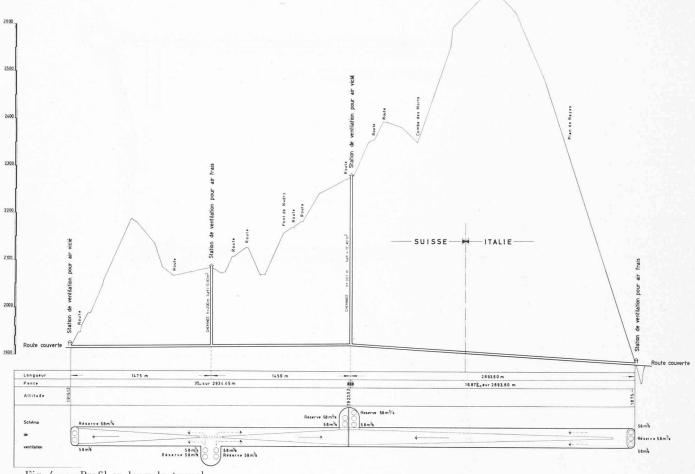
Fig. 4. — Profil en long du tunnel.
