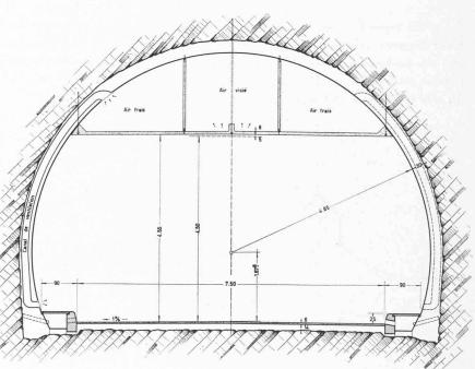
Fig. 5. — Profil en travers-type, côté suisse.
