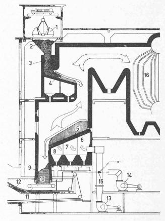
Fig. 2. — Coupe longitudinale schématique du four De Roll:
