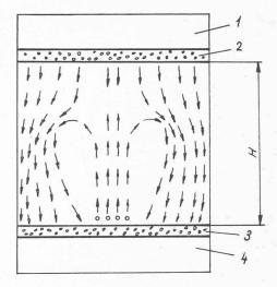
Fig. 3. — Renouvellement par déplacement.
