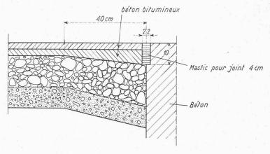
Fig. 7. — Bassin de compensation de Motec. Détail du revêtement du bassin.
