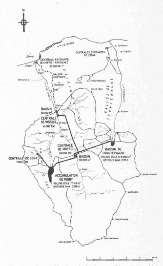
Fig. 1. — Forces Motrices de la Gougra. Plan d'ensemble.
