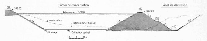
Fig. 5. — Bassin de compensation de Motec. Coupe.
