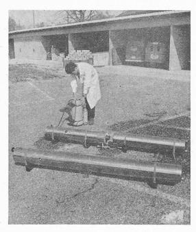
Fig. 1. — Présentation des deux prototypes mis au point. Au premier plan: le générateur thermique CC 451, en une seule pièce; au milieu: le générateur thermique CC 452, en deux éléments de même longueur; à l'arrière-plan: l'agrégat de démarrage, en position verticale.
