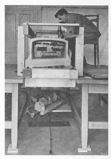
Fig. 1 b. — Modèle en plâtre, mesures optiques des rotations avec miroirs.
