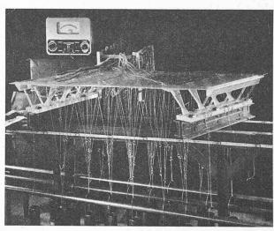
Fig. 7 a. — Modèle en plexiglas à l'échelle 1 : 50.
