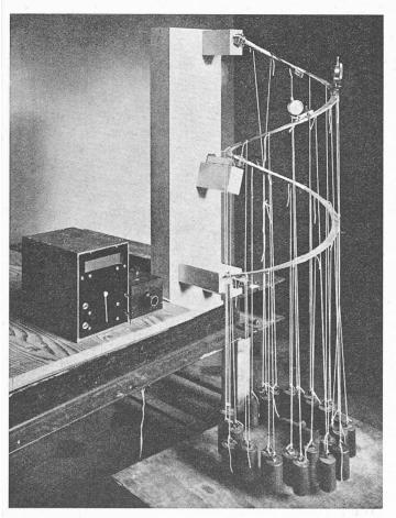
Fig. 2 b. — Modèle réduit. Barre de 5 × 20 mm en anticorodal.
