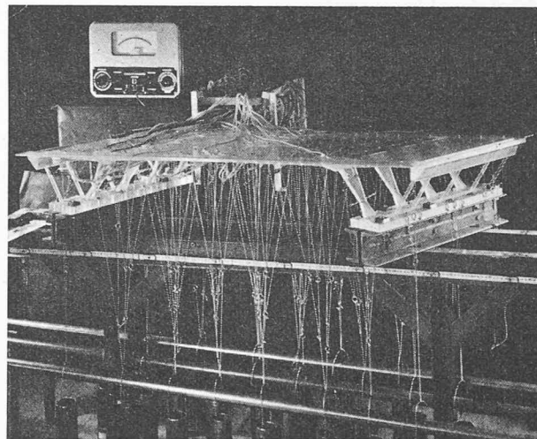
Fig. 7 a. — Modèle en plexiglas à l'échelle 1 : 50.
