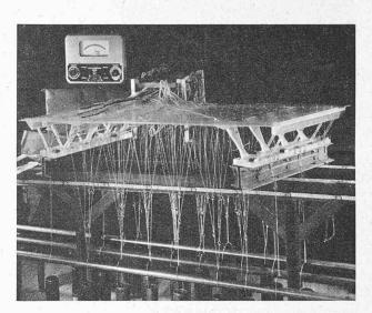
Fig. 2. — Essai sur modèle réduit, en plexiglas, d'un pont biais avec appuis triangulés. Echelle du modèle 1:50.
