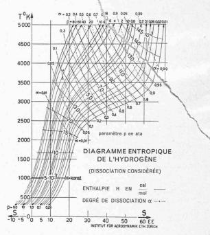
Fig. 5. — Diagramme entropique de l'hydrogène (dissociation prise en considération).
