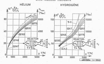
Fig. 4. — A gauche : Impulsion spécifique d'un propulseur à l'hélium en fonction de la température ; rapport d'expansion  $\pi$  comme paramètre. Réacteur nucléaire comme source de chaleur.
