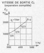
Fig. 7. — Propulseur à radical (chaleur d'association comme source d'énergie).
