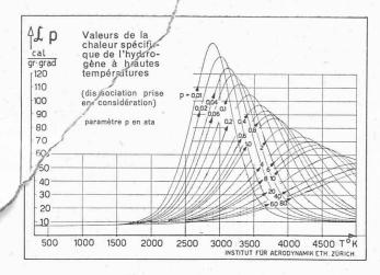
Fig. 2. — Chaleur spécifique moléculaire  $\mathfrak{L}_p$  de l'hydrogène aux hautes températures (dissociation prise en considération); pression p comme paramètre.
