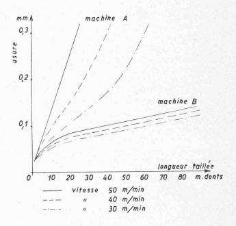
Fig. 1. — Fraises vis en acier rapide à profil non rectifié, trempées ensemble dureté 66 Rc, module 1. Pièces en acier 63 kg, longueur 60 mm, même nombre
