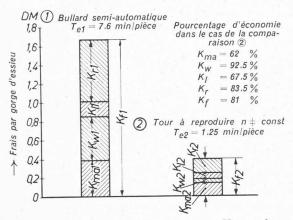
Fig. 22. — Comparaison des frais d'usinage  $K_i$  pour le tournage de gorges d'essieu avec outils en acier rapide — index 1 — et avec outils en carbure de tungstène — index 2.
