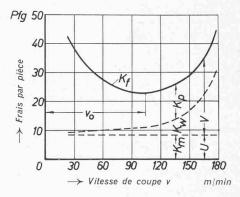
Fig. 20. — Frais d'usinage  $K_l$  par pièce en fonction de la vitesse de coupe  $\rho$ .
