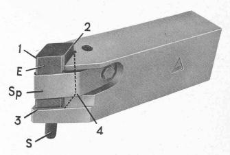
Fig. 10. — Outil à reproduire avec plaque en métal dur fixée mécaniquement (Fried. Krupp, Fabrique Widia, Essen). E: plaquette en métal dur; Sp: bande de fixation; S: vis de protection.
