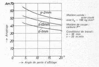
Fig. 6. — Ampérage d'un moteur de tour, en fonction de l'angle de coupe pour différentes avances.
