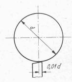
Fig. 18. — Outil se trouvant « plus haut que l'axe de laminage ».
