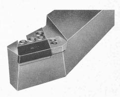
Fig. 11. — Outil de tour avec plaque en métal dur fixée mécaniquement et angle de coupe positif (Fried. Krupp, Fabrique Widia, Essen).
