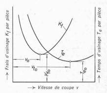
Fig. 21. — Frais d'usinage  $K_l$  et temps d'usinage  $T_e$  par pièce en fonction de la vitesse de coupe  $\wp$ .
