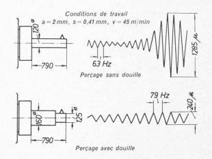
Fig. 4. — Oscillations au cours d'un travail au foret avec et sans douille, selon E. Saljé, Zurich.
