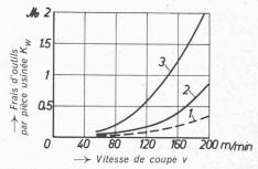
Courbe 1 : burin Courbe 2 : fraiseuse avec tenue de coupe suffisante Courbe 3 : fraiseuse avec tenue de coupe insuffisante
