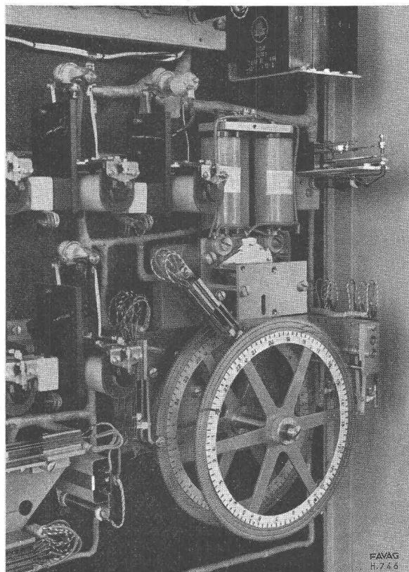
Mouvement distributeur commandé par l'horloge-mère, opérant automatiquement les changements de tarifs et l'émission de signaux de service selon programmes.
