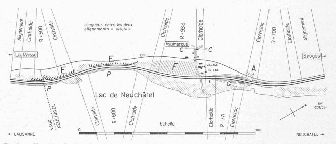
Fig. 3. — Plan général schématique de la correction de Vaumarcus A = ancien passage à niveau de Vaumarcus; C = ancienne route cantonale; E = falaises; F = vignes; G = remblai; P = protection du remblai
