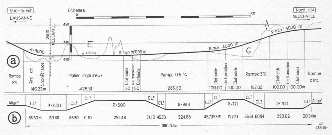
Fig. 6. — (a) Profil en long de l'axe (b) Schéma des sinuosités A = ancien passage à niveau; E = falaises; G = remblai
