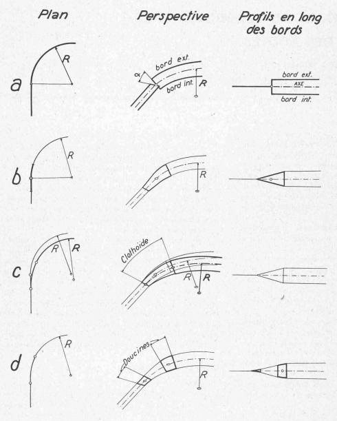
Fig. 2. — Evolution de la surface de raccordement
