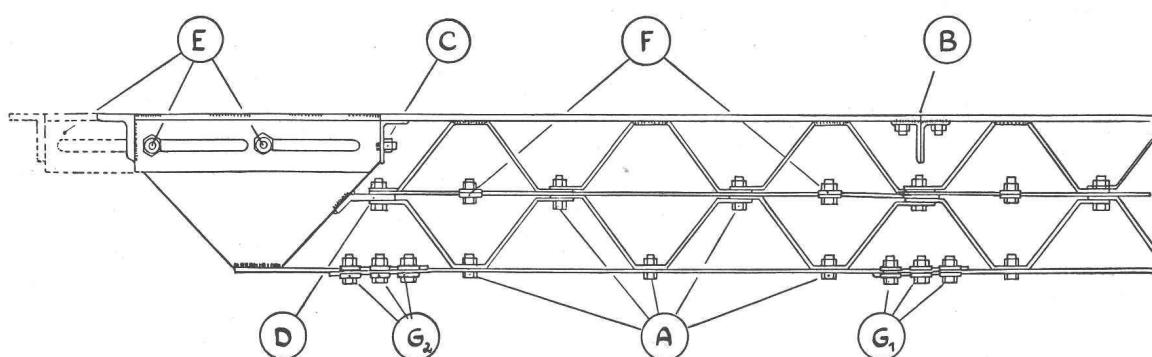
être supportés par les poutrelles BK. Lors de tous les montages avec poutrelles BK, il est possible d'augmenter à volonté le nombre de fers de raidissement latéraux pour parer à des poussées éventuelles supplémentaires. Lors de coffrage de réservoirs ou silos, l'élément supérieur de la poutrelle BK seul sera utilisé le plus souvent ; il en résulte une utilisation très réduite de matériel.
